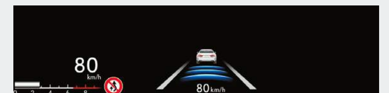
はみ出し通行禁止標識表示
