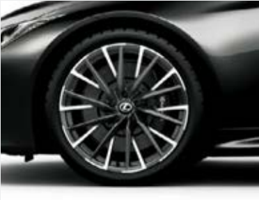
フロント245/40R21+リヤ275/35R21タイヤ&鍛造アルミホイール (切削光輝+スーパークロスブラックメタリック塗装)*1
