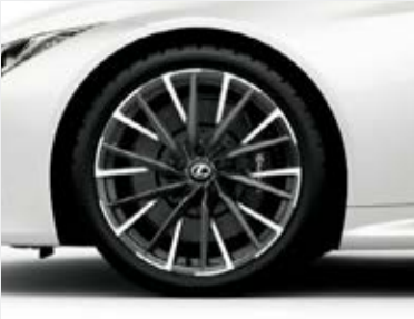
フロント245/40R21+リヤ275/35R21タイヤ&鍛造アルミホイール(切削光輝+スーパースパークロスブラックメタリック塗装)*1
