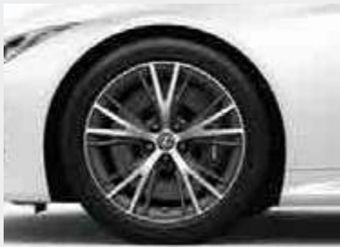
フロント245/45RF20＋リヤ275/40RF20 ランフラットタイヤ&ノイズリダクション アルミホイール(切削光輝)*1
