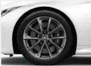
フロント245/45RF20＋リヤ275/40RF20 ランフラットタイヤ&鍛造アルミホイール (ダークプレミアムメタリック塗装)*1
