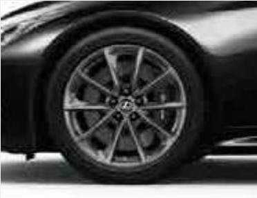
フロント245/45RF20+リヤ275/40RF20 ランフラットタイヤ&鍛造アルミホイール (ダークプレミアムメタリック塗装)*1
