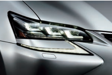
三眼フルLEDヘッドランプ (ロー・ハイビーム) & LEDフロントターンシグナルランプ
