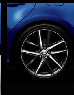
フロント235/40R19+ リヤ265/35R19タイヤ & "F SPORT"専用アルミホイール (切削光輝) *3
