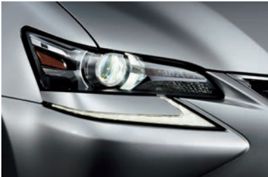
LEDヘッドランプ (ロー・ハイビーム/インテリジェントAFS付)
