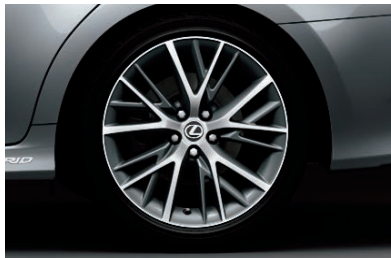
235/40R19タイヤ & *version L* 専用ノイズリダクション アルミホイール(切削光輝)
