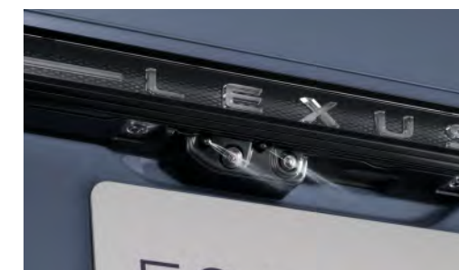
バックカメラ洗浄イメージ
