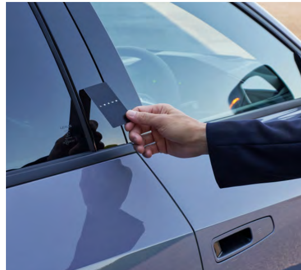
NFCキーカードを運転席側センターピラーにタッチ
