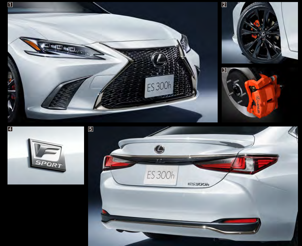
①“F SPORT”専用スピンドルグリル(メッシュタイプ/漆黒メッキモール) & “F SPORT”専用サイドガーニッシュ(ダークグレーメタリック塗装) ②235/40R19タイヤ & “F SPORT”専用アルミホイール(ブラック塗装) ③“F SPORT”専用オレンジブレーキキャリパー(フロントLEXUSロゴ) ④“F SPORT”専用エンブレム(フロントフェンダー) ⑤“F SPORT”専用リヤバンパーロアガーニッシュ(漆黒メッキ) / “F SPORT”専用ラゲージドアガーニッシュ(漆黒メッキ) / リヤスポイラー ※④⑤はメーカーオプションの“F SPORT”専用オレンジブレーキキャリパー(フロントLEXUSロゴ)を装着しています。
